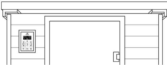
Legen Sie das Dach mit den Lampen nach unten auf die Infrarotkabine, sodass sich die zwei Lautsprecher hinten befinden. Positionieren Sie zwischen Dach und den Wänden die dreieckigen Styroporecken, mit denen die Infrarotkabine geliefert worden ist. Dadurch verhindern Sie, dass die Kabel eingeklemmt werden.
