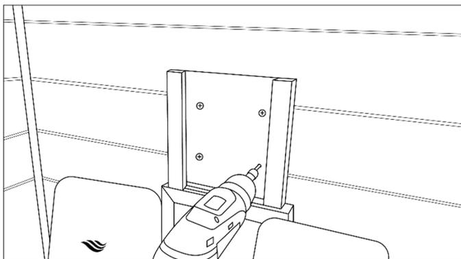
Positionieren Sie das Brett der Kopfstütze mittig oberhalb des Rückenstrahlers zwischen den flexiblen ergonomischen Rückenlehnen und schrauben Sie diese mit den mitgelieferten Schrauben (**4 Stück 30 mm**) an die Rückwand. Anschließend verdecken Sie die Löcher mit den mitgelieferten Abdeckungen und schieben die Kopfstütze in die Führungsschienen.
