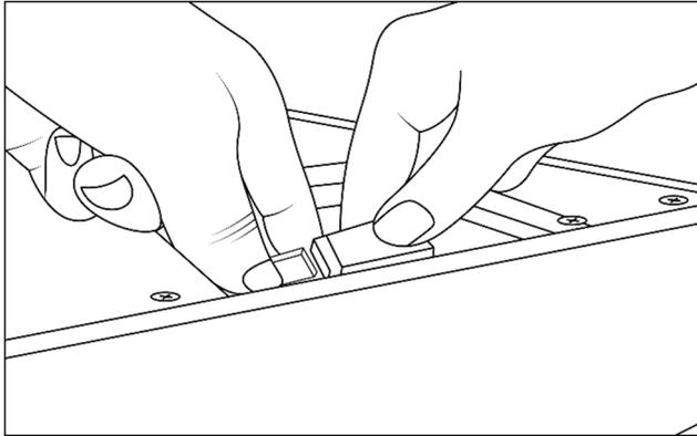
An der Oberseite der Infrarotkabine befinden sich die elektrischen Anschlüsse.
