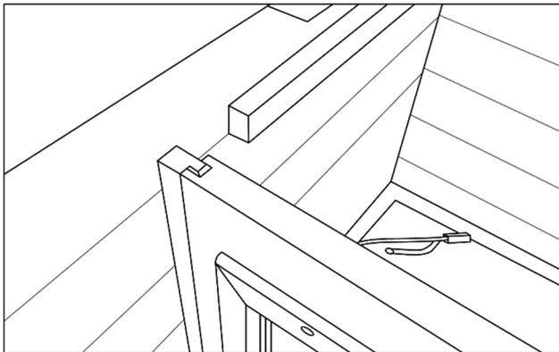
Schieben sie den Wadenwärmestrahler in die seitlichen Führungsschienen. Der Strahler muss dabei, wie abgebildet, in Ihre Richtung zeigen.
