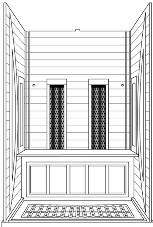
Schieben Sie jetzt die Sitzbank von vorne über den Wadenwärmestrahler und unter den Schulterstrahlern an den Leisten entlang bis an die Rückwand, während die zweite Person vorsichtig die Seitenwände auseinander drückt.
