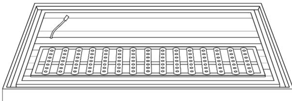
Kontrollieren Sie die Unterseite auf etwaige Fremdkörper und entfernen Sie diese, bevor Sie die Bodenplatte auf den gewünschten Standort legen. Sollten Sie nicht genügend Platz für den Zusammenbau haben, so können Sie, bei entsprechendem Bodenbelag (Parkett, Fliesen), den Aufbau neben dem gewünschten Aufstellungsort vornehmen und die Infrarotkabine anschließend vorsichtig verschieben.
