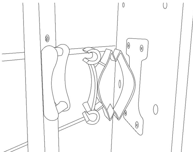
Verbinden Sie die Kunststoffelemente durch vorsichtiges, ruckartiges Drücken miteinander. Die Elemente rasten mit einem Klickgeräusch ein. Überprüfen Sie, dass alle Elemente gut verbunden sind.
