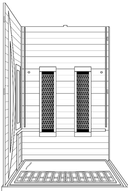
Platzieren Sie die linke Seitenwand rechtwinkelig zu der Rückwand auf den Boden so, dass die Aussparungen passen. Heben Sie die Seitenwände an, bis die Metallbolzen in der Höhe der Löcher der Einhängenvorrichtung sind. Drücken Sie die Seitenwand an die Rückwand und achten Sie darauf, dass die Metallbolzen in die Einhängenvorrichtungen einrasten. Die Seitenwand und die Rückwand müssen oben plan abschließen.
