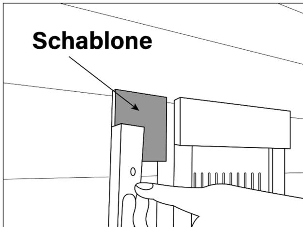
Für links und für rechts gibt es unterschiedliche Holzstege (mit drei Kunststoffhalterungen), die jeweils nach innen zeigend montiert werden müssen. Sie werden mit einem Abstand von 4 cm zum Rückenstrahler befestigt. Halten Sie dazu die mitgelieferte Schablone neben dem Rückenstrahler an, sodass diese oben mit dem Strahler abschließt. Schrauben Sie jetzt den Steg oben mit **einer 40 mm Schraube** an.
