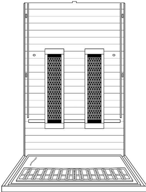
Stellen Sie die Rückwand mit den Infrarotstrahlern nach innen auf die Bodenplatte in die dafür vorgesehene Aussparung. Dabei sollte die Rückwand seitlich mit den Leisten der Bodenplatte abschließen.
