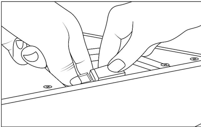
In den Wartungsschächten an der Oberseite der Infrarotkabine befinden sich die elektrischen Anschlüsse. Verbinden Sie die Steckverbindungen in den Schächten. Beachten Sie, dass in einigen Schächten zwei Steckverbindungen verbunden werden müssen.
