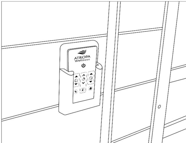
Die Halterung für die Fernbedienung können Sie an jeder gut erreichbaren Stelle mittels doppelseitigen Klebbands oder den beigefügten Schrauben (**2 Stück 30 mm**) montieren. Achten Sie bitte darauf, dass sich die Montagestelle nicht direkt über einem Infrarotstrahler befindet, da die aufsteigende Wärme die Fernbedienung beschädigen könnte.
