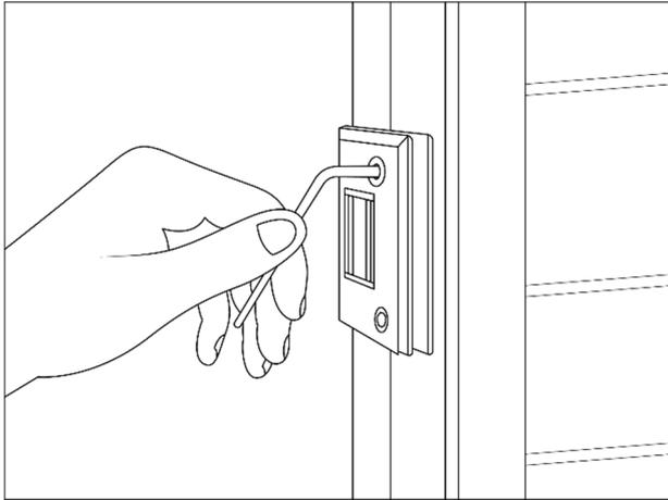
Ziehen Sie bitte die Schrauben der Scharniere der Glastür mit Hilfe eines 4 mm Sechskantschlüssels (Inbus) nach. Gegebenenfalls können Sie die Glastür noch nachjustieren, indem Sie alle Schrauben ein wenig lockern und, am besten zu zweit, die Glastür einrichten.
