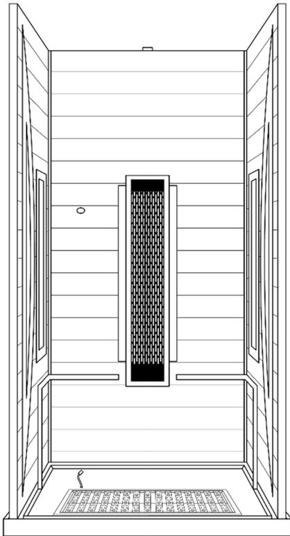
Platzieren Sie die Seitenwände rechtwinklig zu der Rückwand auf den Boden, so dass sie in die Aussparung passen. Heben Sie die Seitenwände an, bis die Metallbolzen in der Höhe der Löcher der Einhängenvorrichtung sind. Drücken Sie die Seitenwand an die Rückwand und achten Sie darauf, dass die Metallbolzen in die Einhängenvorrichtungen einrasten. Die Seitenwände und die Rückwand müssen oben plan abschließen.
