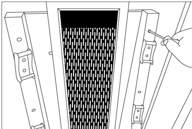
Schrauben Sie die Holzstege mit den Halterungen für die flexiblen Rückenlehnen direkt neben den Führungsschienen an, so dass sie mit ihnen oben plan abschließen (**je 3 Stück 50 mm** Schrauben). Der Abstand zwischen den beiden Holzteilen beträgt somit etwa 32 cm.
