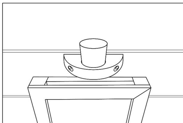
Die Halterung mit dem Glasschälchen sollte mittig über einem Tiefenwärmestrahler montiert werden (**2 Stück 40 mm** Schrauben). Der Abstand zwischen dem Strahlerrahmen und der Halterung muss mindestens 2 cm betragen. Wir empfehlen, die Löcher mit einem 2 - 3 mm Holzbohrer vorzubohren.
