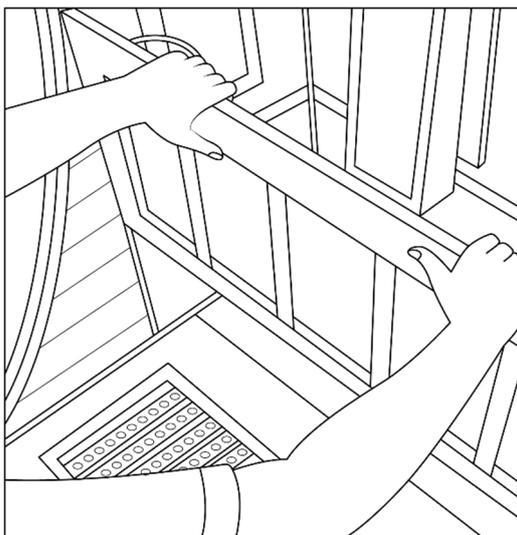
Schieben Sie den Wadenstrahler in die seitlichen Führungsschienen. Der schwarze Flächenstrahler muss dabei, wie abgebildet, in Ihre Richtung zeigen. Achten Sie darauf, dass Sie keine Kabel einklemmen. Schließen Sie jetzt die **beiden Steckverbindungen** vom Wadenstrahler und Boden an.
