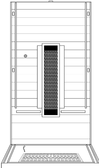
Stellen Sie die Rückwand mit den Infrarotstrahlern nach innen auf die Bodenplatte in die dafür vorgesehene Aussparung. Dabei sollte die Rückwand seitlich mit den Leisten der Bodenplatte abschließen.
