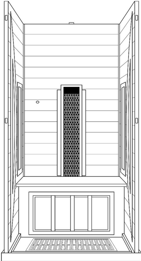
Drücken Sie, am besten zu zweit, die beiden Seitenwände vorsichtig auseinander und schieben Sie gleichzeitig die Sitzbank auf den Wadenstrahler und die Leiste an die Rückwand.
