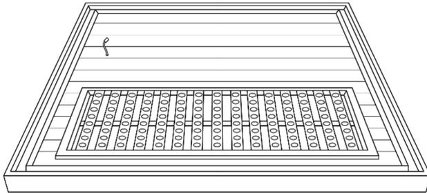
Kontrollieren Sie die Unterseite auf etwaige Fremdkörper und entfernen Sie diese, bevor Sie die Bodenplatte auf den gewünschten Standort legen. Verwenden Sie bei Bedarf Filzgleiter. Sollten Sie nicht genügend Platz für den Zusammenbau haben, so können Sie bei entsprechendem Bodenbelag (Parkett, Fliesen) den Aufbau neben dem gewünschten Aufstellungsort vornehmen und die Infrarotkabine anschließend vorsichtig verschieben.
