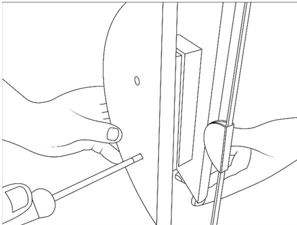
Montieren Sie den Türgriff (**2 Stück 50 mm metrisch**). Dazu stecken Sie eine Schraube durch das obere Loch des Innengriffs und das obere Loch in der Glastür. Schrauben Sie jetzt den Außengriff an. Verfahren Sie dementsprechend mit der zweiten Schraube.
