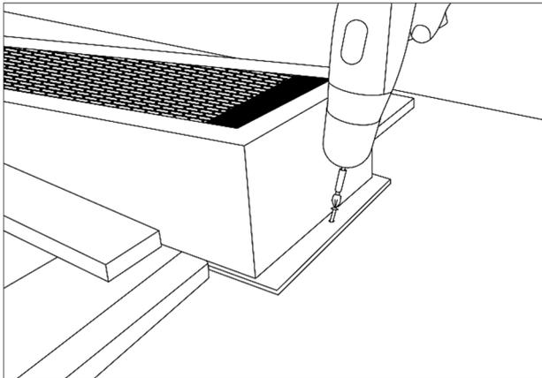
Schrauben Sie anschließend die Fixierungsschraube (1 Stück 30 mm) an der Unterseite des Strahlers fest.
