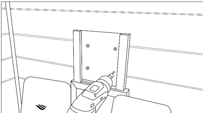
Positionieren Sie das Brett der Kopfstütze mittig oberhalb des Rückenstrahlers zwischen den flexiblen ergonomischen Rückenlehnen und schrauben Sie diese mit den mitgelieferten Schrauben (**4 Stück 30 mm**) an die Rückwand. Anschließend verdecken Sie die Löcher mit einer der mitgelieferten Abdeckungen und schieben Sie die Kopfstütze in die Führungsschienen.
