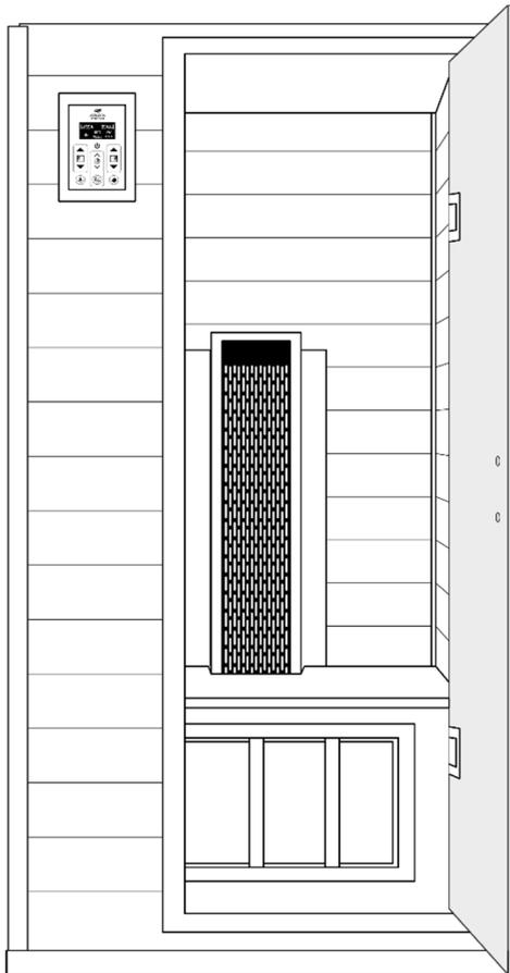
Heben Sie jetzt, am besten zu zweit, die Frontwand auf die Bodenplatte.
