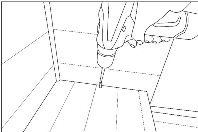
Bitte befestigen Sie die Sitzbank mit Hilfe **2 Stück 30 mm** Schrauben an die Leiste an der Rückwand.
