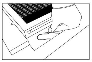
Verstecken Sie die Steckverbindungen und Kabel hinter dem Strahler. Schieben Sie jetzt den Strahler ganz nach oben, wobei Sie darauf achten, dass die Steckverbindungen und Kabel hinter dem Strahler verschwinden und nicht eingeklemmt werden.
