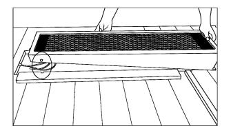
Beginnen Sie mit der Montage der Rückenstrahler an die Seitenwände. Sie dazu die ieweilige Legen Seitenwand auf den Boden oder auf eine andere gerade und stabile Ebene. Positionieren Sie den Rückenstrahler zwischen den zwei Führungsschienen. Die beiden Zapfen müssen dabei in die vorgesehenen Aussparungen Führungsschienen (ovaler Kreis auf der Abbildung) geführt werden.
