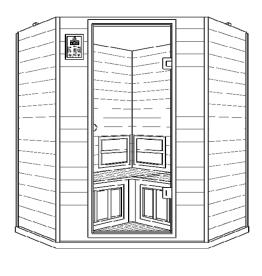
Heben Sie jetzt, am besten zu zweit, die Frontwand auf die Bodenplatte.
