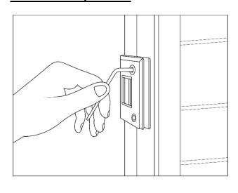
Ziehen Sie bitte die Schrauben der Scharniere der Glastür mit Hilfe eines 4 mm Sechskantschlüssels (Inbus) nach. Gegebenenfalls können Sie die Glastür noch nachjustieren, indem Sie alle Schrauben ein wenig lockern und, am besten zu zweit, die Glastür einrichten.
