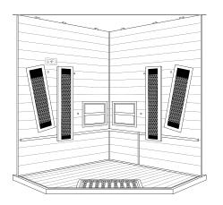
Stellen Sie eine Rückwand mit den Infrarotstrahlern nach innen auf die Bodenplatte in die dafür vorgesehene
