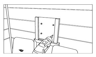
Positionieren Sie das Brett der Kopfstütze mittig oberhalb des Rückenstrahlers zwischen den flexiblen Rückenlehnen ergonomischen und schrauben Sie diese mit den mitgelieferten Schrauben (4 Stück 30 mm) an die Rückwand. Anschließend verdecken Sie die Löcher mit einer der mitgelieferten Abdeckungen und schieben Sie die Kopfstütze in die Führungsschienen.
