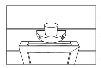
Die Halterung mit dem Glasschälchen sollte mittig über einem Tiefenwärmestrahler montiert werden (2 Stück 40 mm). Der Abstand zwischen dem Strahlerrahmen und der Halterung muss mindestens 2 cm betragen. Wir empfehlen, die Löcher mit einem 2 - 3 mm Holzbohrer vorzubohren.
