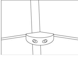
Nach Abschluss der Montagearbeiten können Sie aus optischen Gründen die Schnellverschlüsse gegen die geschraubten Eckverbinder aus Holz tauschen. (je 2 Stück 40 mm)
