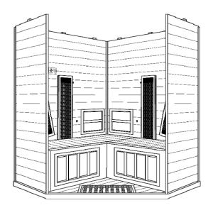
Platzieren Sie die Seitenwände nacheinander rechtwinklig zu den Rückwänden auf dem Boden. Eine Person hält die Seitenwand schräg, während die zweite Person die Steckverbindungen verbindet.
