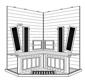
Legen Sie die beiden Sitzbänke auf die Wadenstrahler und die Leisten, die an den Wänden angebracht sind. Die kürzere Sitzbank befindet sich rechts.
