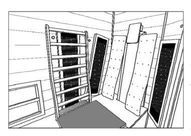
Sie die mobile Stellen Rückenlehne vor einen der beiden vertikalen Infrarotstrahler. Dadurch wird die Bestrahlung von Körperpartien ermöglicht, die bei halbliegenden den Positionen nicht ausreichend bestrahlt werden kann (z.B. die Nieren). Die Neigung der mobilen Rückenlehne können Sie ändern, indem Sie die Abstandsbretter an der Unterseite herausklappen.
