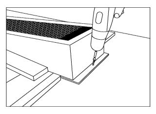
Schrauben Sie anschließend die Fixierungsschraube (1 Stück 30 mm) an der Unterseite des Strahlers fest.
