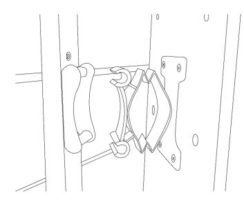
Verbinden Sie die Kunststoffelemente durch vorsichtiges ruckartiges Drücken miteinander. Die Elemente rasten mit einem Klickgeräusch ein. Überprüfen Sie. Elemente dass alle gut verbunden sind.
