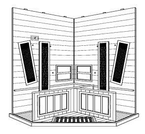
Stellen Sie den längeren Wadenwärmestrahler, parallel zur linken Rückwand, auf die Bodenplatte und in die Führungsschiene an der rechten Rückwand. Der Wärmestrahler muss dabei, wie abgebildet, in Ihre Richtung zeigen, das Kabel zur Rückwand. Verfahren Sie dementsprechend mit dem zweiten Wadenwärmestrahler.
