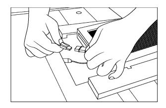
Verbinden Sie die Steckverbindung an der Oberseite des Strahlers. Überprüfen Sie anschließend, ob der Stecker und das Kabel fest miteinander verbunden sind.
